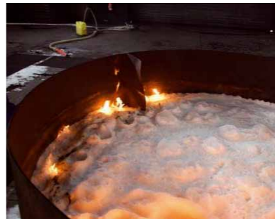
Abbildung 2 und 3: Gasblasen mit Flüssigkeitsdampf und Zündung der Gasblasen
